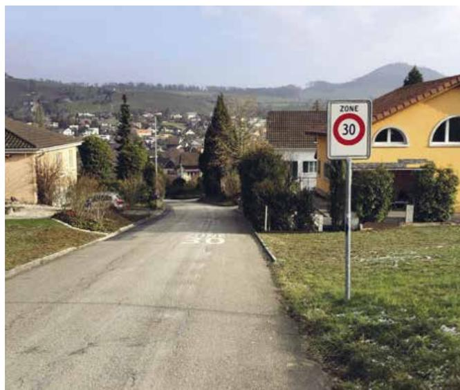
Abbildung: Beispiel aus Magden AG für die einfache Signalisation und Markierung einer Tempo-30-Zone
